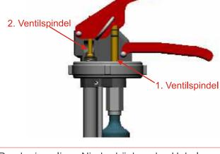
Durch einmaliges Niederdrücken des Hebels aktiviert die 1. Spindel die CO<sub>2</sub>-Patrone, während die 2. Spindel das Löschmittel dosiert.
