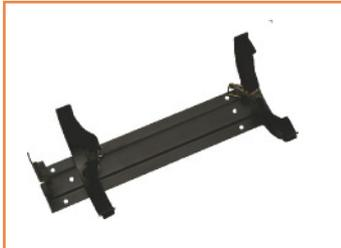
10-006 **KFZ-Halter für Feuerlöscher 6 kg**, Stahlblech, pulverbeschichtet, schwarz, RAL 9005, mit zwei Spannbändern aus Polypropylen, mit Metallverschluss
