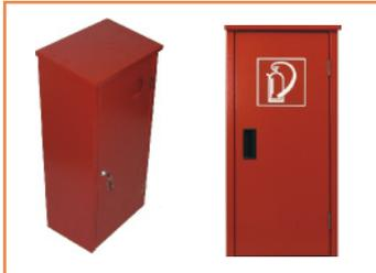
10-300S **Aufputz-Schutzschrank** für 6+12 kg Feuerlöscher, Stahlblech, verzinkt, pulverbeschichtet, rot, RAL 3000, mit schrägem Dach, Tür mit Edelstahlscharnieren, Kunststoff-Griffmuschel, Türöffnungswinkel 180°, Maße: 720 x 340 x 220 mm (HxBxT)
