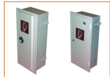
10-308 **Wandebau-Schutzschrank**, für 12 kg Löscher, Stahlblech, verzinkt, pulverbeschichtet, weiß, RAL 9010, Drehgriff aus Aluminium, Türöffnungswinkel 180°, Maße: 700 x 300 x 220 mm (HxBxT) Erforderliches Nischenmaß: 720 x 320 x 220 (HxBxT)
